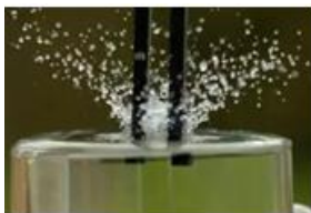
C. 发声的音叉激起水花，说明音叉在振动
